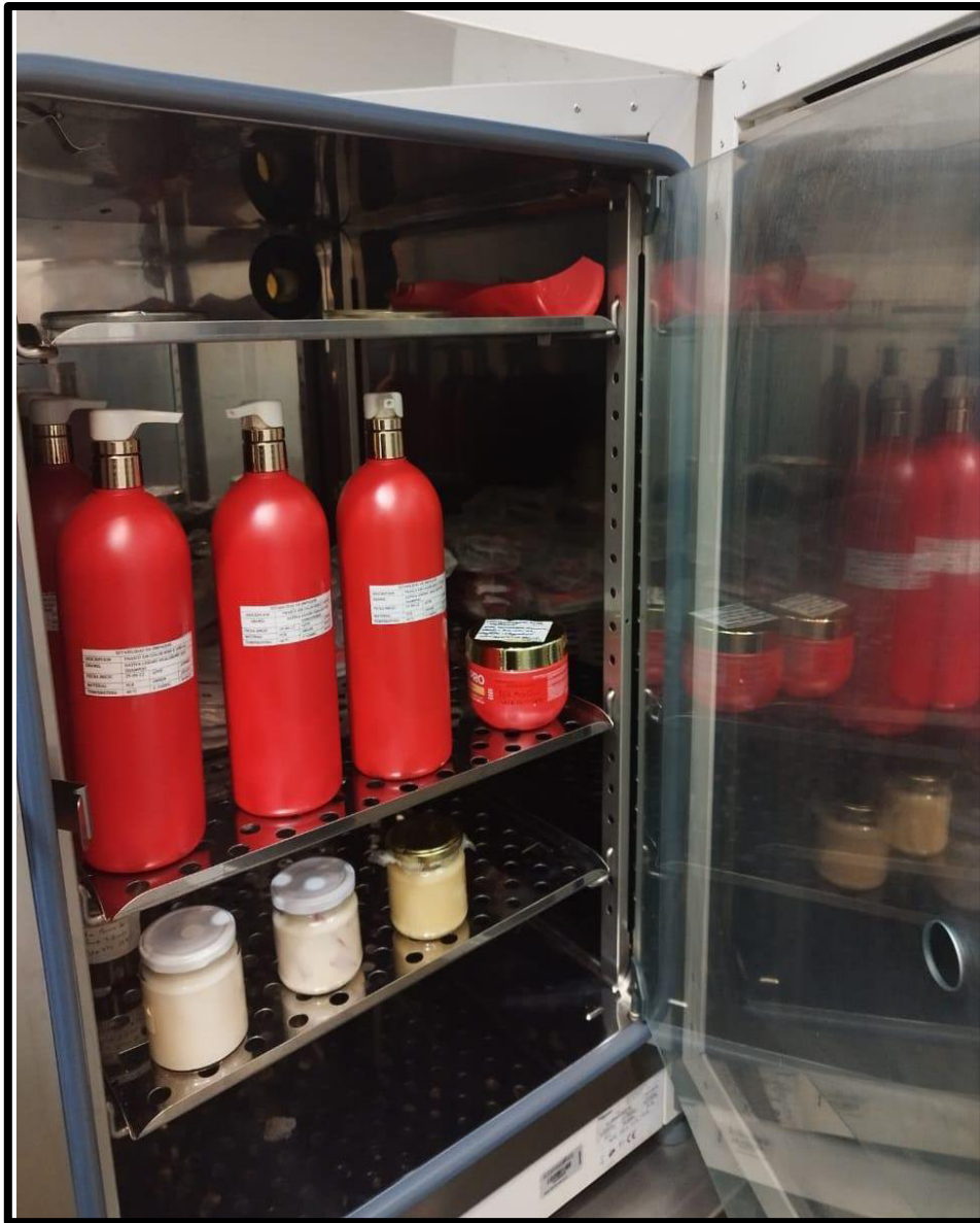
Figura 4: Muestras en evaluación en estufas a 40°C.
