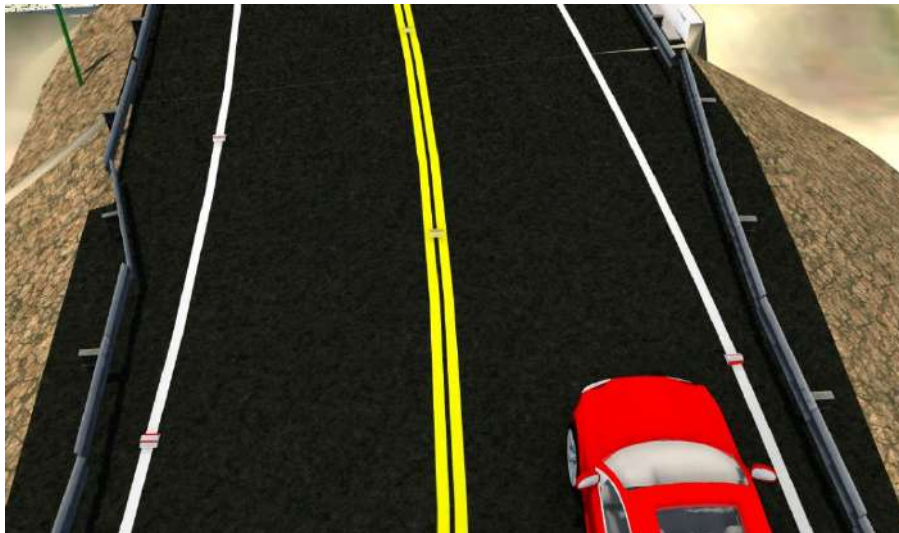
Figura N°04: Vista de la Primera transición de ensamblajes Margen Derecha - Modelo actualizado sincronizado con los planos emitidos en Infracworks
