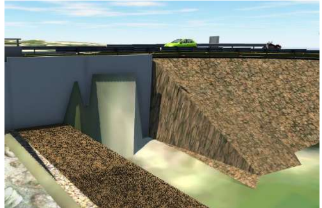
Figura N°04 : Talud de relleno Margen Izq. – Aguas Abajo
