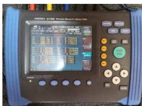
Figura 23. Programación y registro de parámetro eléctrico relevantes para análisis Fuente propia
