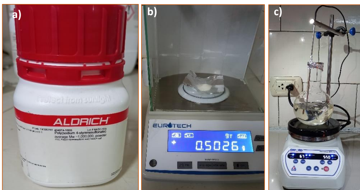
Fig. 3.1 a) PSS b) cantidad medida del polímero c) agitación de la solución del polímero en agua destilada. Este polímero no produjo grumos.
