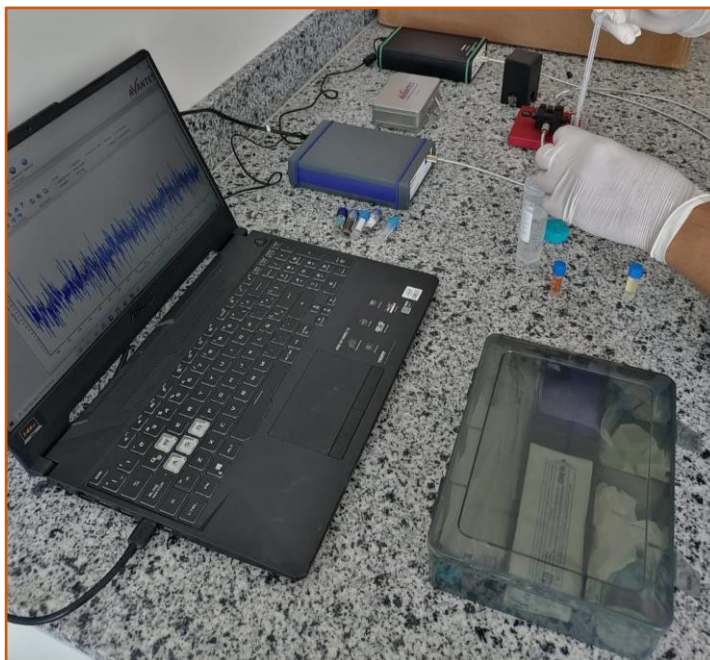
Fig. 3.8 Esquema de trabajo empleado en el análisis de la muestra RV1 por UV-Vis marca AVANTES disponible en el Laboratorio NANOTECH de la Facultad de Ciencias Físicas de la Universidad Nacional Mayor de San Marcos.
