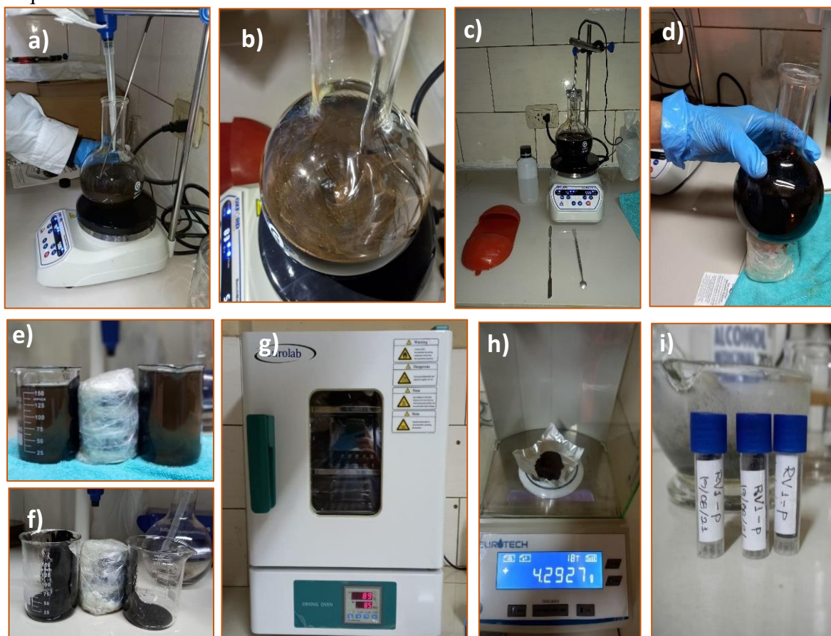
Fig. 3.3 a) La solución rojiza se torna oscura al agregar el \text{NH}_4\text{OH} b) se mantiene la agitación y la temperatura en el agitador magnético c) tras media hora de agitación dejamos reposar la solución d) realizamos la decantación con ayuda de un imán de neodimio y enrasamos con agua destilada, esto se debe realizar hasta verificar que el agua retirada tenga un pH neutro e) vertemos el contenido en beakers después de limpiar al menos cinco veces con el imán entre los beakers f) retiramos el agua sobrante y en este paso aprovechamos para retirar 2 mL de esta muestra en tubos portamuestra para el análisis micro-Raman g) dejamos en calefacción por un espacio de 2 horas a 80 °C h) finalizado el proceso trituramos con un mortero de borosilicato y medimos la masa del resultado sobre trozos de papel de aluminio y i) finalmente colocamos una cantidad en tubos portamuestra para su caracterización posterior por DRX.
