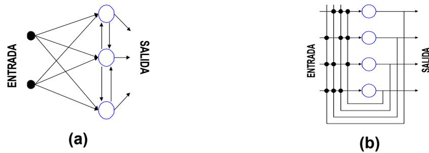
**Figura 5.5** Redes Monocapa (a) Con conexiones laterales (b) Red Recurrente
