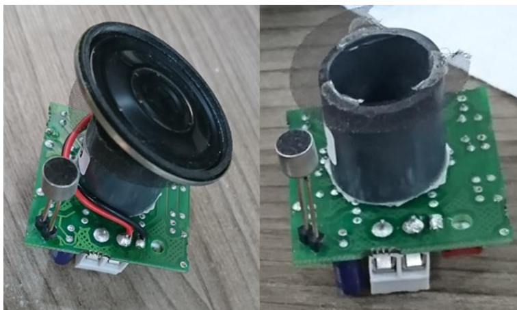
Figura 24: Reparación del módulo de audio U-AM. Fuente: Actividad laboral.
