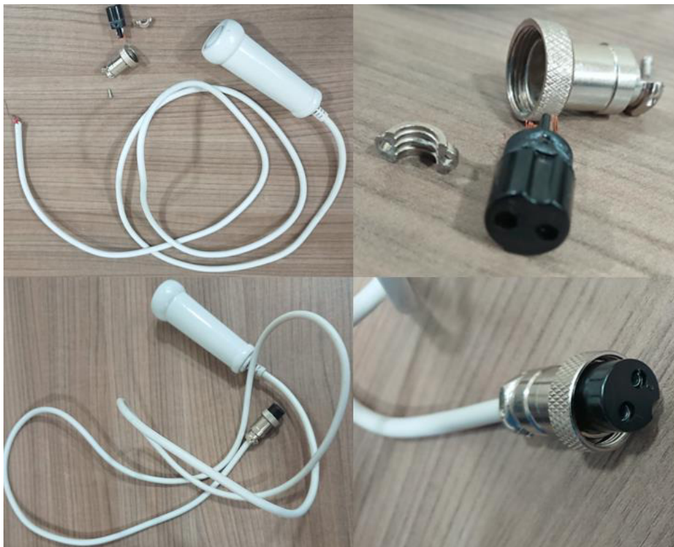
Figura 36: Reparación del conector del pulsador de timbre CC-200. Fuente: Actividad laboral.
