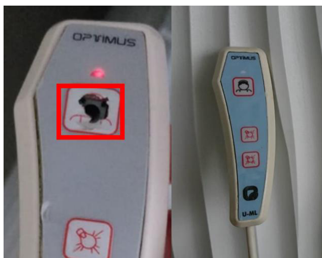
Figura 25: Cambio de lámina de cubierta para pulsador de timbre U-ML. Fuente: Actividad laboral.
