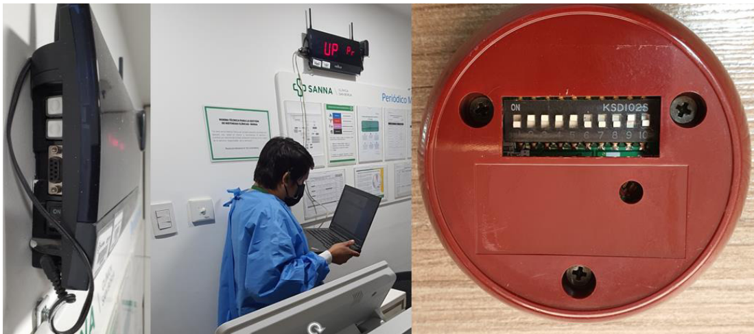
Figura 45: Configuración de timbre inalámbrico Vellux. Fuente: Actividad laboral.
