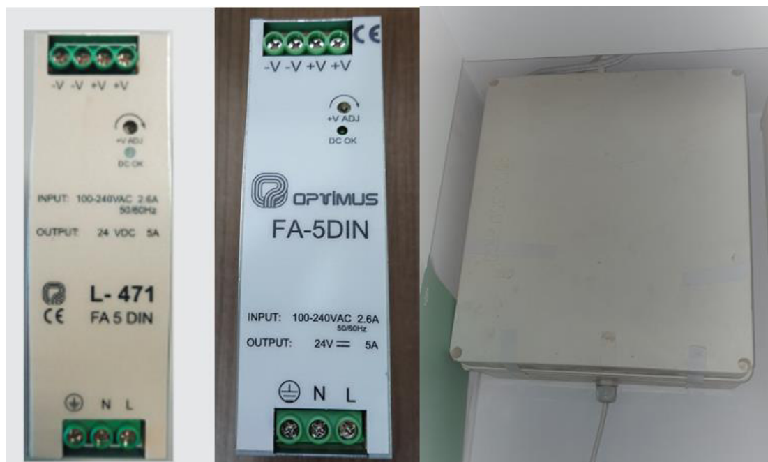
Figura 18: Fuente de alimentación Optimus / Modelo: L-471(FA 5 DIN). Fuente: Actividad laboral.
