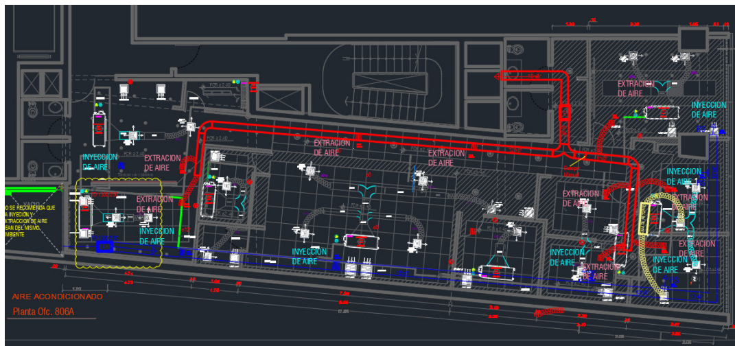
figura 30. Optimización sistema de ventilación
