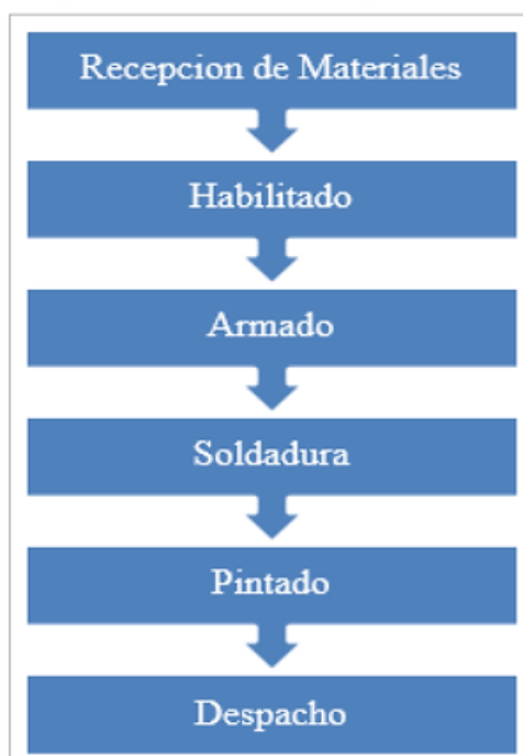
GRÁFICO 7: SECUENCIA DE LOS PROCESOS DE FABRICACIÓN DE LOS COMPONENTES DE LAS ESTRUCTURAS METÁLICAS.
