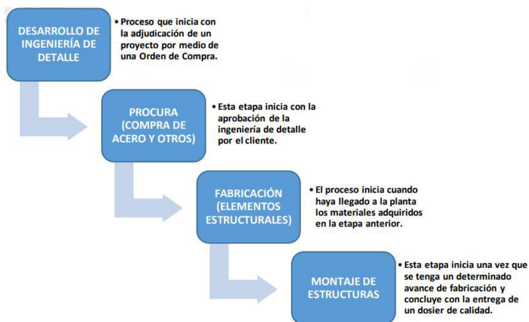
GRÁFICO 5: PROCESO SECUENCIAL PARA LA FABRICACIÓN Y MONTAJE DE ESTRUCTURAS METÁLICAS DENTRO DE LA EMPRESA METALIKAS S.A.C
