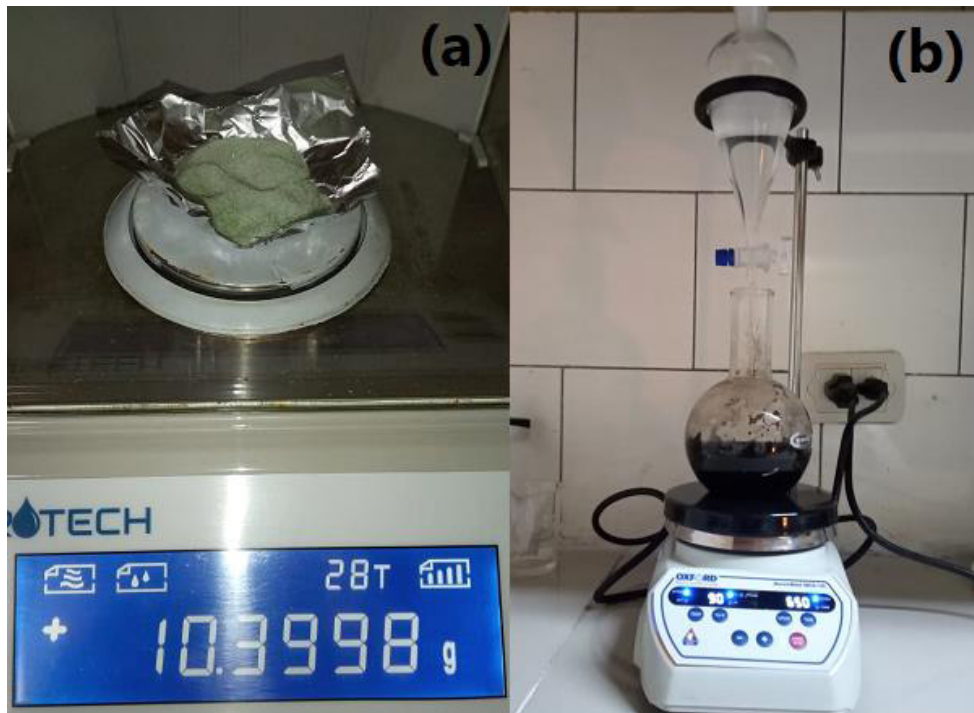
Figura 3.3. Procedimiento de síntesis de D3 en laboratorio del grupo de investigación NANOTECH por el método de co-precipitación, (a) CTAB en balanza micrométrica, (b) goteo de \text{NH}_4\text{OH} para precipitación de NPs.
