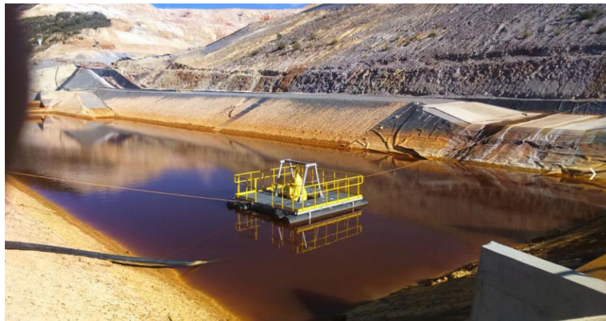
Figura 7: Bomba sumergible en barcaza operando en una poza.
