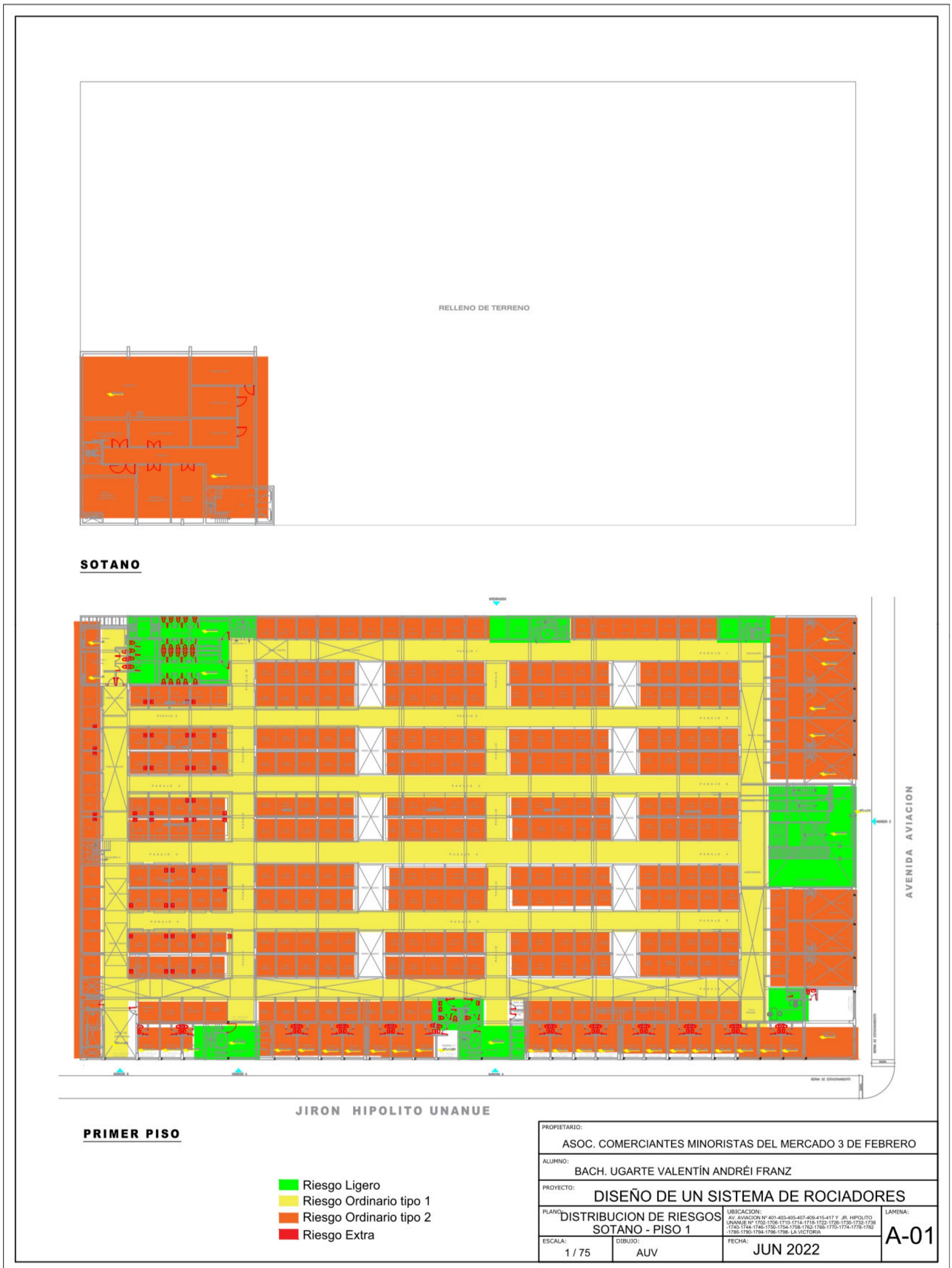
Figura 33. Plano de distribución de Riesgos Sótano 1 – Piso 1
