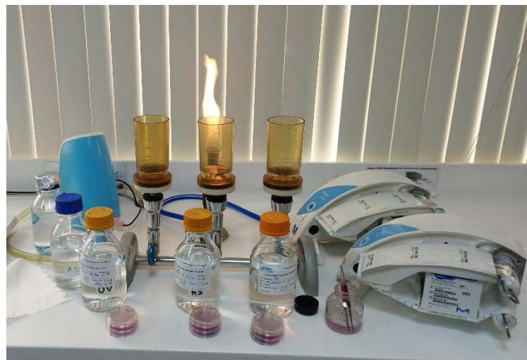
Figura 5. Procesamiento de muestras por método de filtración
