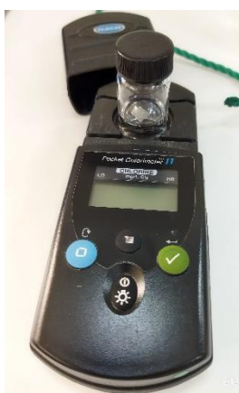
Figura 11. Equipo medidor de Cloro. Pocket Colorimeter II de HACH
