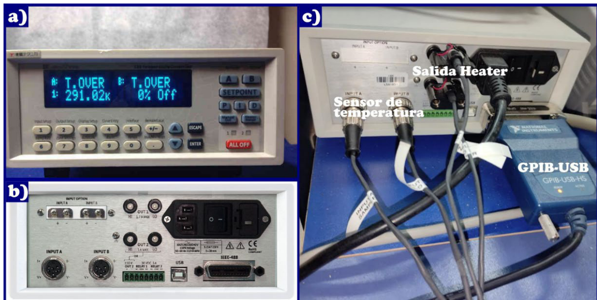
Figura 36. (a) Panel frontal, (b) panel posterior y (c) conexión de los sensores, heater y adaptador GPIB-USB del controlador Lakeshore 335 [30].
