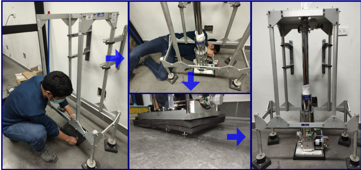
Figura 19. Esquema de trabajo para el anclaje del cabezal frío (SRDK Series CRYOCOOLER RDK-408D2).
