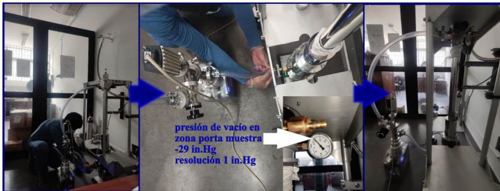
Figura 25. Acoplamiento de las mangueras de vacío con las válvulas con brida NW-25 del criostato.
