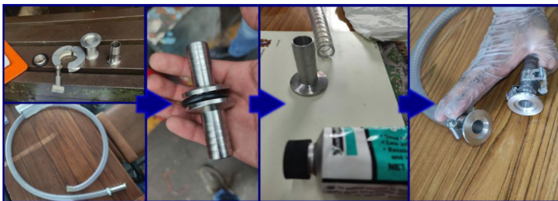
Figura 24. Proceso de construcción de mangueras de vacío con materiales ubicados en Lima - Perú.
