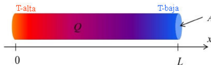
Figura 1. Flujo de calor en una varilla lineal con extremos a diferente temperatura [11].
