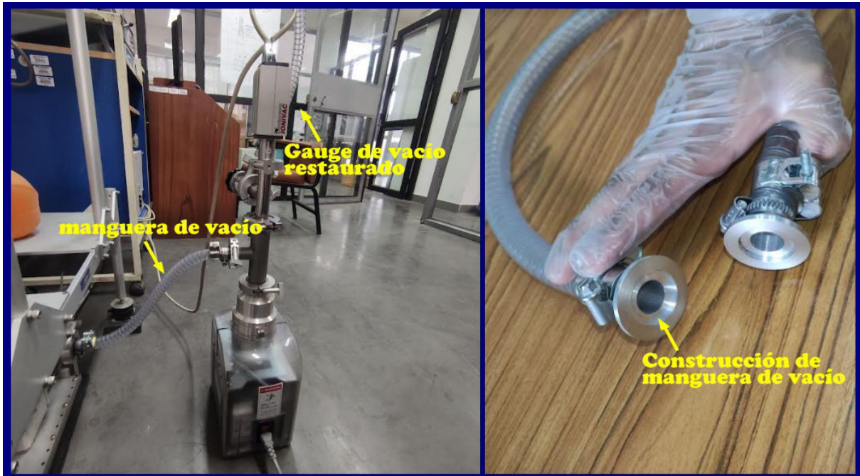
Figura 45. Resultados de la restauración del sensor de vacío Ionovac ITR-90 y de la construcción de mangueras de vacío.
