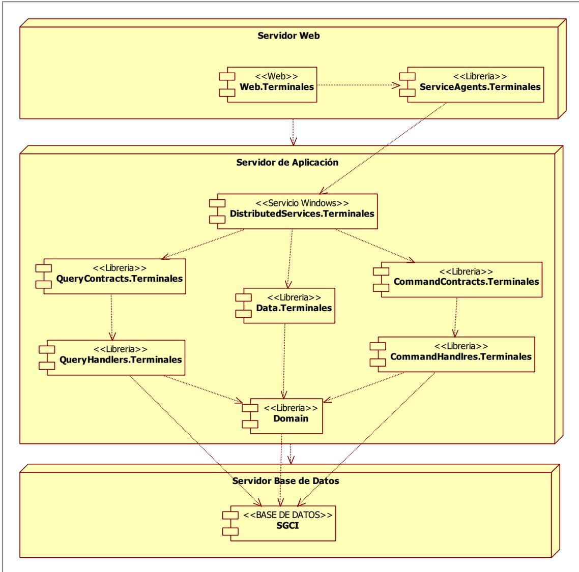
Nota. Se muestra el diagrama de despliegue de componentes que se ha implementado en el sistema. Fuente. Elaboración propia.
