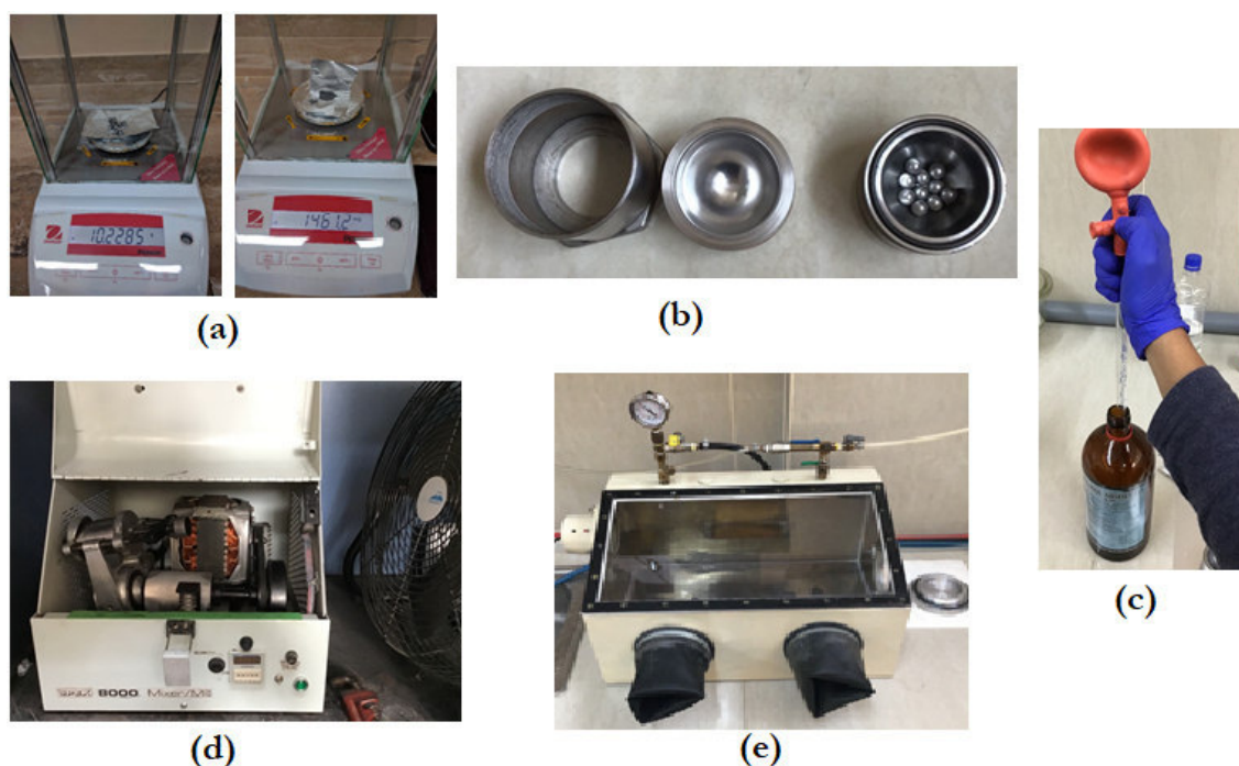
Figura 3.3: (a) Relación de masas billas-muestra, (b) Contenedor de acero inoxidable, (c) Reactivo surfactante: Etanol, (d) Molino vibratorio de alta energía SPEX 8000, (e) Cámara de control ambiental.
