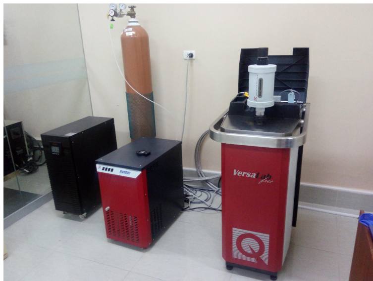
Figura 3.5: Magnetómetro de muestra vibrante, marca Versa-Lab, modelo Quantum Design.
