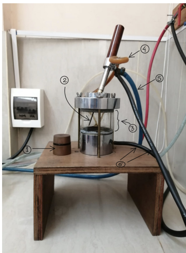
Figura 2.9: Horno de arco voltaico. Los reactivos elementales son ubicados en un (1) banco de cobre, los cuales son aleados usando un (2) electrodo de tungsteno dentro de una (3) cámara por el cual circula un gas inerte. (4) y (5) son parte del sistema de refrigeración. (6) diferencia de voltaje.
