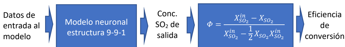
Figura 46 Sensor virtual obtenido para la predicción de la eficiencia de conversión. Fuente: Elaboración propia.
