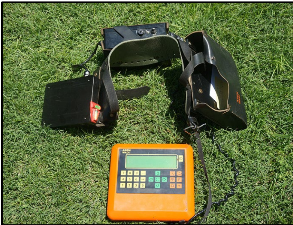
Figura 3.10: Instrumento VLF diseñado por la empresa ABEM WADI.
