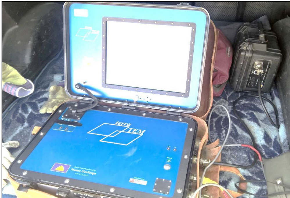
Figura 3.8: Equipo Terratem de Monex GeoScope
