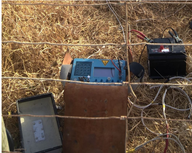
Figura 3.2: Detalle del resistímetro modelo SYSCAL PRO y la batería.
