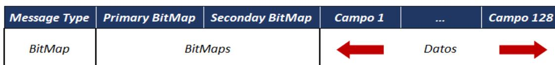
**Figura 12. Estructura general de un mensaje del ISO 8583**
