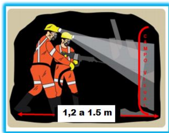
Figura 13 Campo visual con la iluminación de lámparas mineras en un frente de perforación con máquina neumática Jackleg.
