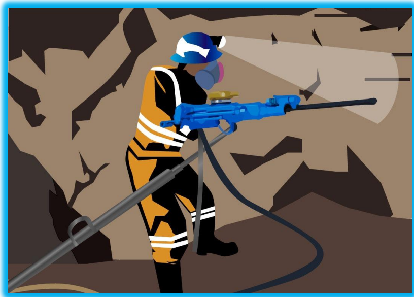
Figura 15 Vista de los sobreesfuerzos de los miembros superiores y la espalda para desplazar (empujar) la máquina Jackleg contra la roca.
