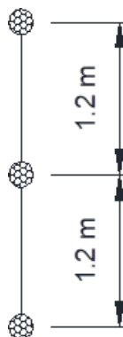
Figura 12 Disposición de conductores en las estructuras. Fuente: Elaboración propia, 2021.
