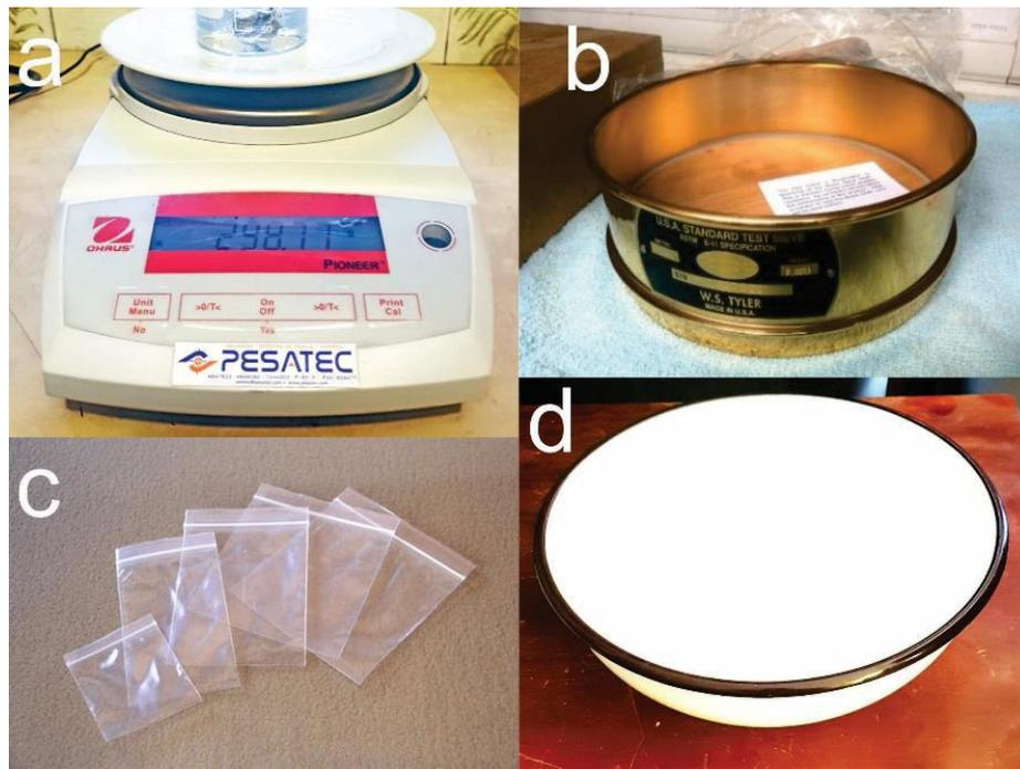
*Nota:* a. Balanza electrónica Ohaus modelo cp4102. b. Tamiz (“Sieve”). c. Bolsas con cierre hermético. d. Bol (recipiente de porcelana cóncava de 25 cm de diámetro).
