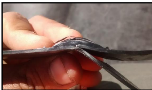
Fig 47.- Tira de 2cm x 30 cm, vista en sección, para su posterior ensayo.
