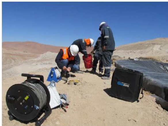
Foto n°01: Medición del Nivel Freático del Inclínometro-Piezómetro PZ-IN - 01.
