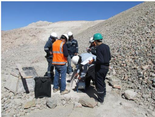
Foto n°05: Medición del Nivel Freático del Inclínometro-Piezómetro PZ-IN - 02.
