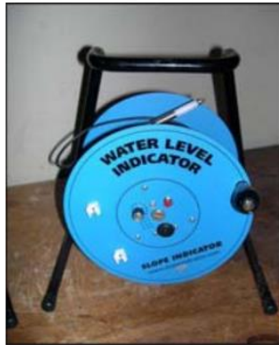
Fig 13.- Instrumentación geotécnica, piezómetro tipo casa grande (izquierda) y equipo indicador de nivel de agua (derecha).
