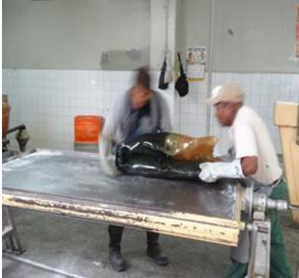
10.11. Acondicionamiento del caramelo para su traslado a mezcladora automática
