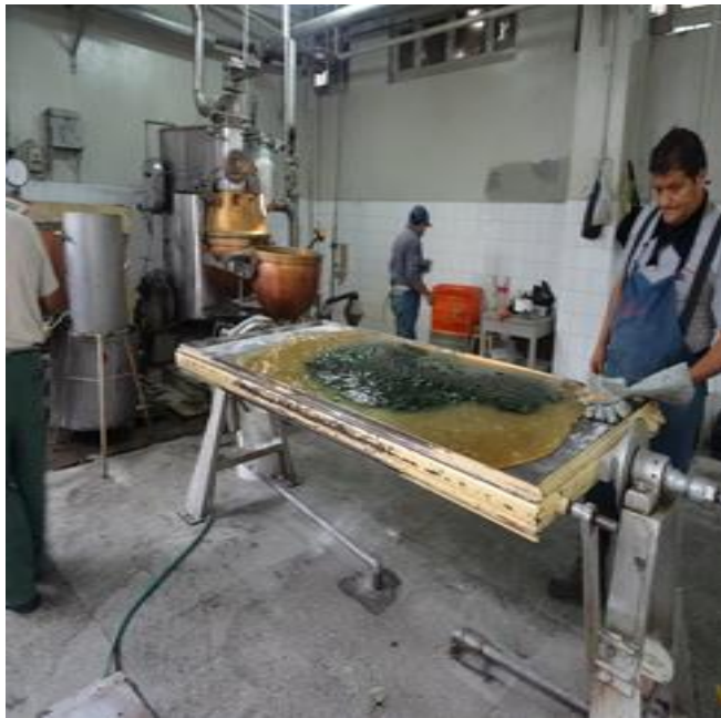
10.8. Regulación del enfriamiento de la masa de caramelo.
