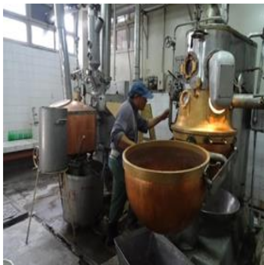
10.3. Equipo de evaporación y descarga paila de cobre.
