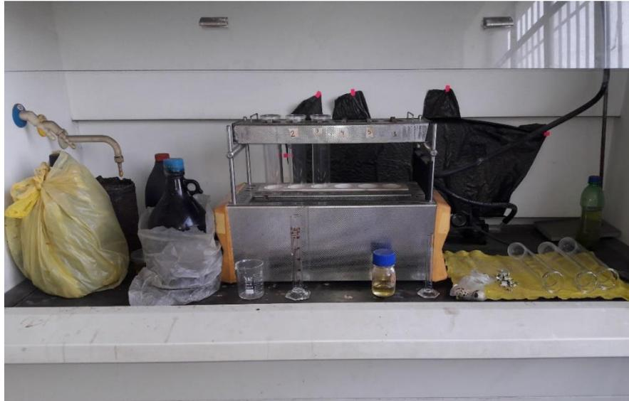
Figura 38. Aparato de digestión (digestor) de Kjeldahl, en campana de extracción
