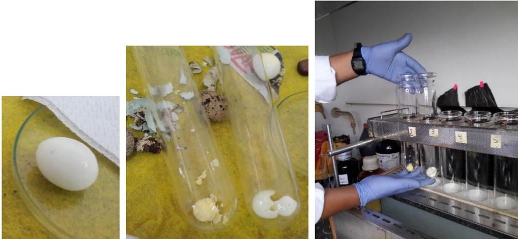
Figura 42. Muestra de huevo de codorniz luego de ser pesada y tubos de digestión conteniendo la yema y clara, separados y separados previamente.
