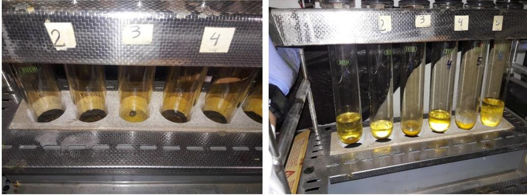
Figura 48. Evolución del proceso de digestión (izquierda generación de vapores de NO<sub>2</sub>, derecha, soluciones producidas al terminar el proceso).
