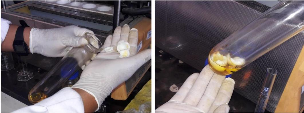
Figura 44. Muestras siendo introducidas e introducidas en tubos de digestión.
