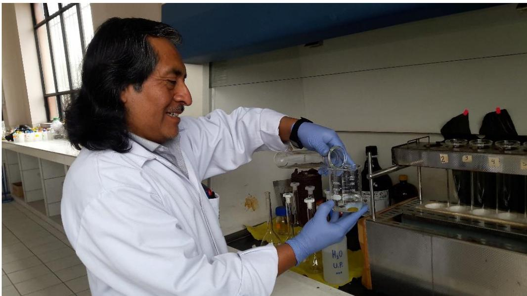
Figura 51. Trasvasado del tubo de digestión al vaso de precipitado (beaker) para ser añadido en el matraz aforado o fiola.
