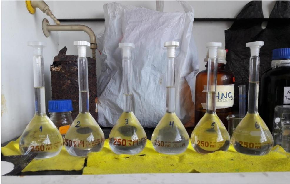
Figura 54. Muestras de huevo de codorniz luego de mineralización húmeda. Las soluciones se han enrasado a 250 mL
