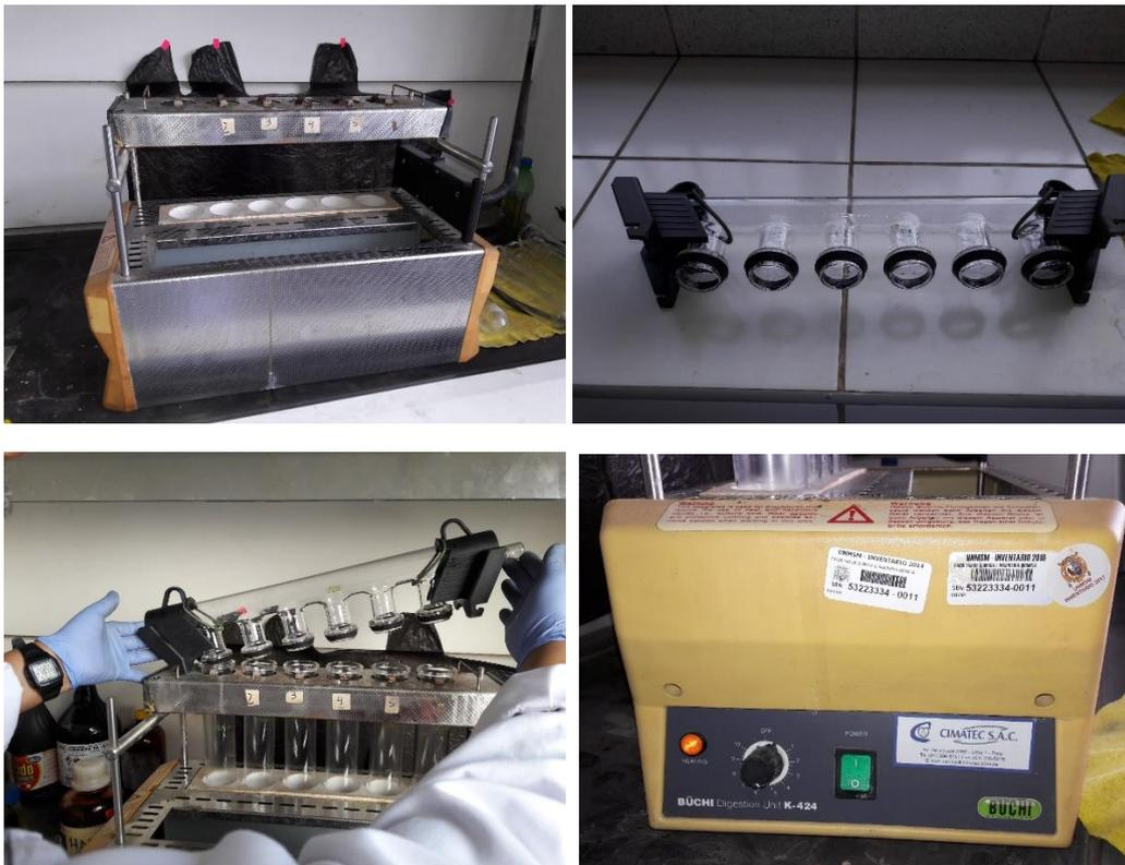
Figura 39. Aparato de digestión (digestor) de Kjeldahl, acoplado sus componentes y parte frontal del mismo.
