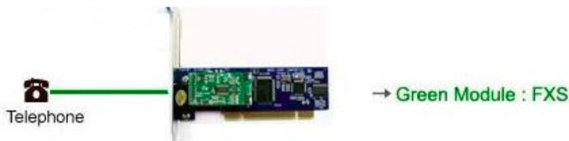
Figura 12: Tarjeta de Comunicaciones FXS
