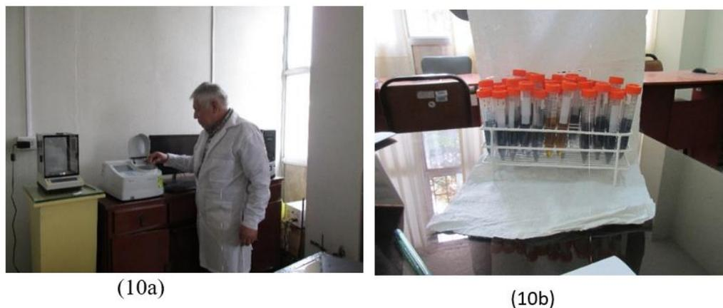
**Figura 10: (10a) Espectrofotómetro Thermo Modelo GENESYS™ 10S UV/Vis, (10b) Muestras con el reactivo DNS, para la determinación de azúcares en el espectrofotómetro.**
