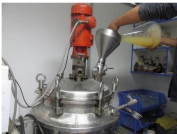
**Figura 25:** Inoculación del jugo con levaduras *S. cerevisiae* para iniciar el proceso de fermentación alcohólica.
