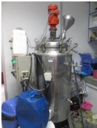
**Figura 24:** Biorreactor utilizado en las pruebas experimentales del proceso de fermentación alcohólica.
