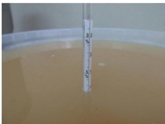
**Figura 12: Determinación de la densidad del jugo de cabuya con densímetro de medida triple (densidad, % de azúcar y temperatura).**
