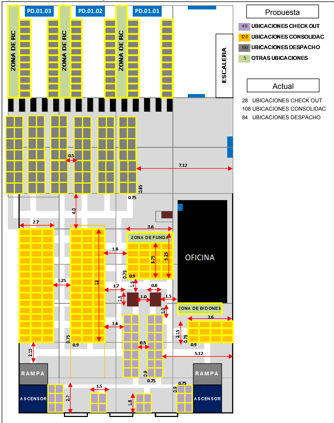
Figura 3.16. Demarcación del flujo de salida
