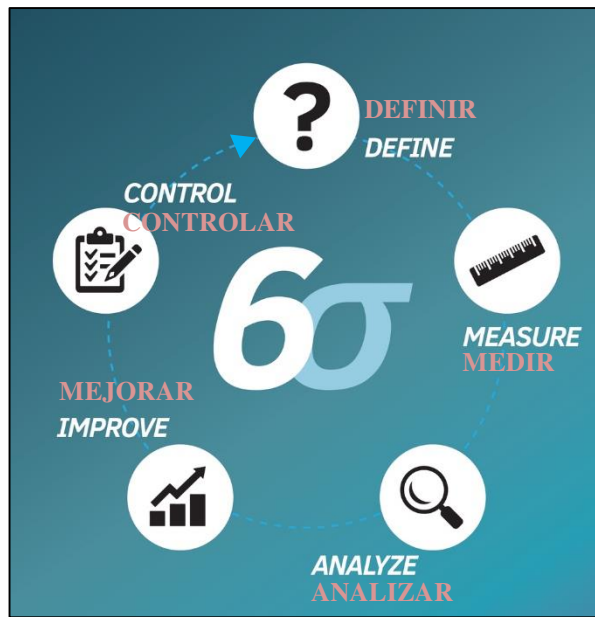
Figura 1. Metodología DMAIC. Las 5 fases de la metodología DMAIC: definir, medir, analizar, mejorar y controlar. Fuente: Creative Safety Supply. 7
