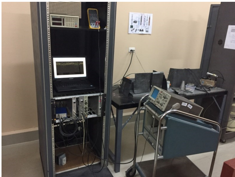
Figura 3.19 Equipo de espectroscopía Mössbauer de transmisión con una fuente de radiación de ^{57}\text{Co} incrustada en una matriz de Rodio (Rh) utilizada para la medición de las muestras de \text{Al}_5\text{Fe}_2 .
