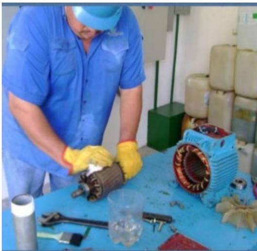
**Figura 12: Limpieza de un motor trifásico de baja potencia**
