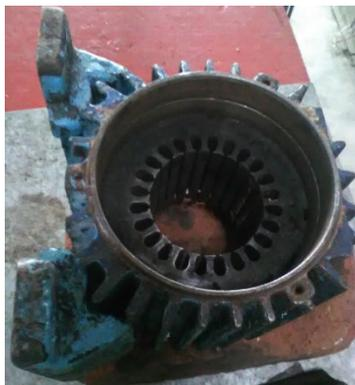
**Figura 13: Estator limpio de un motor eléctrico trifásico.**
