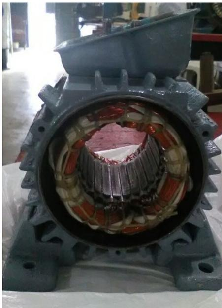
**Figura 14: Estator bobinado de un motor eléctrico trifásico.**
