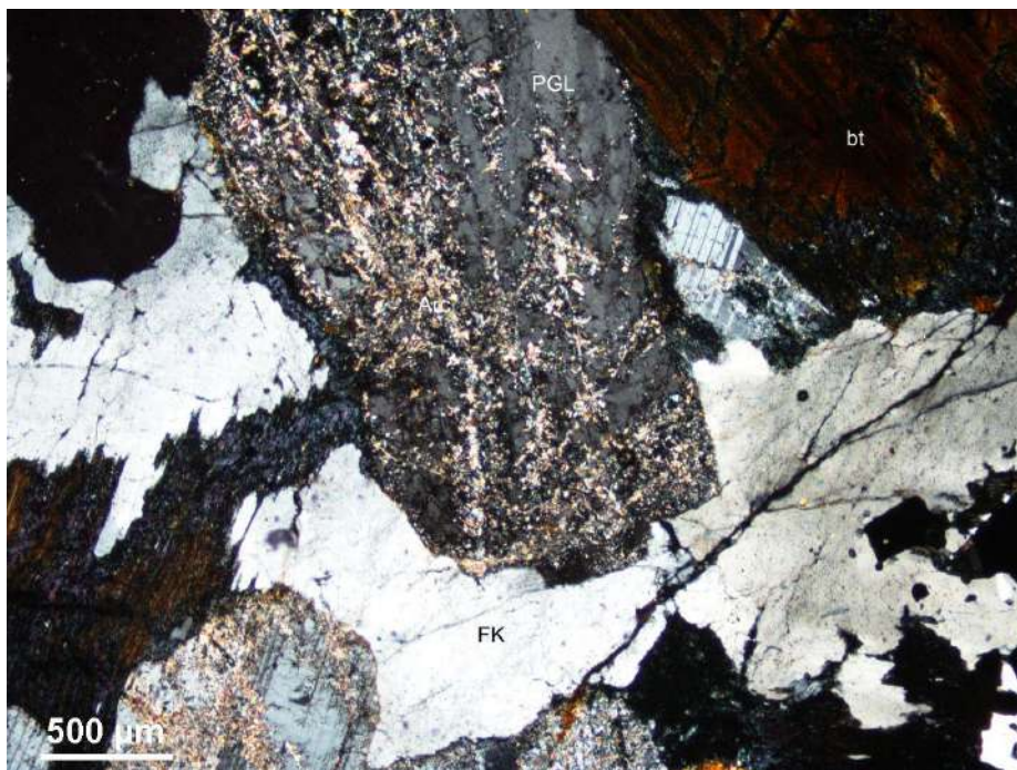
Fotografía 8.13.- Intrusivo sienogranito con feldespato potásico (FK), plagioclasa (PGL), cuarzo, biotita (bt) cloritizándose y minerales opacos diseminados. Todo con fuerte argilitización supérgena. Máficos epidotizados. Muestra 22i-R-078A
