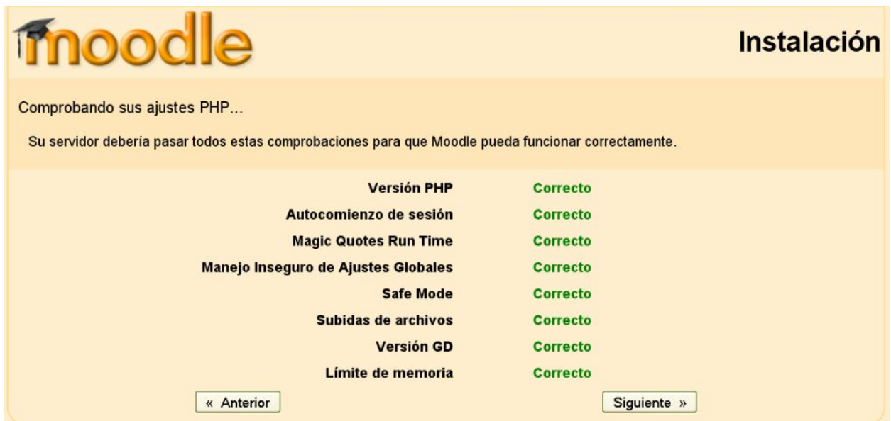
Figura16: Comprobación de la configuración y paquete mínimo de opciones y librerías de php, fuente propia
