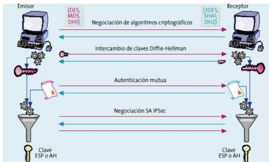
**Figura 3.11 Funcionamiento del Protocolo IKE**
