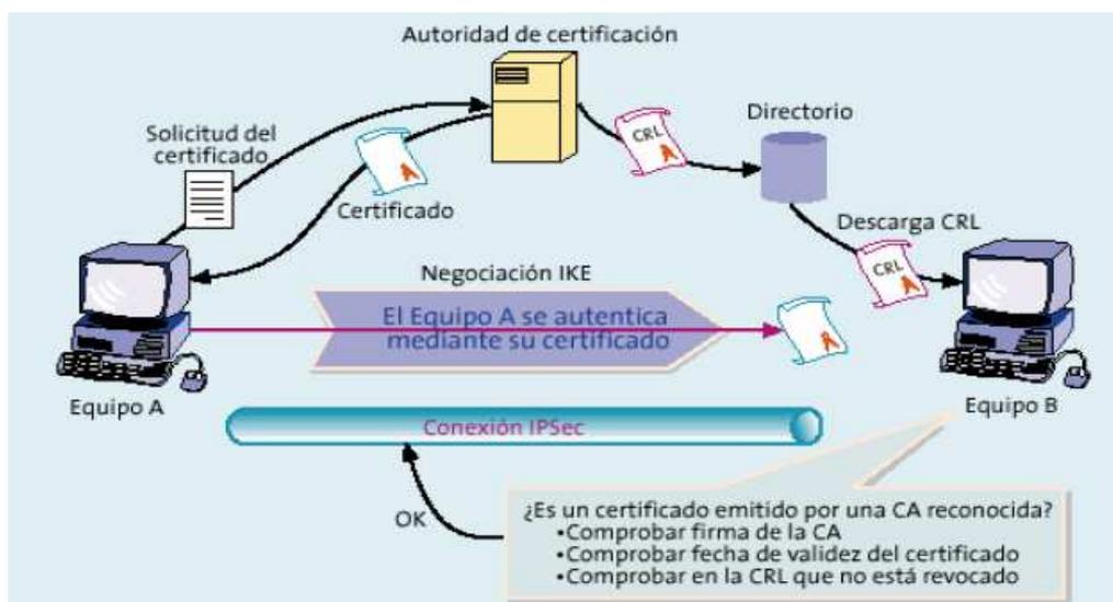
**Figura 3.12 Integración de una PKI con una IPsec**
