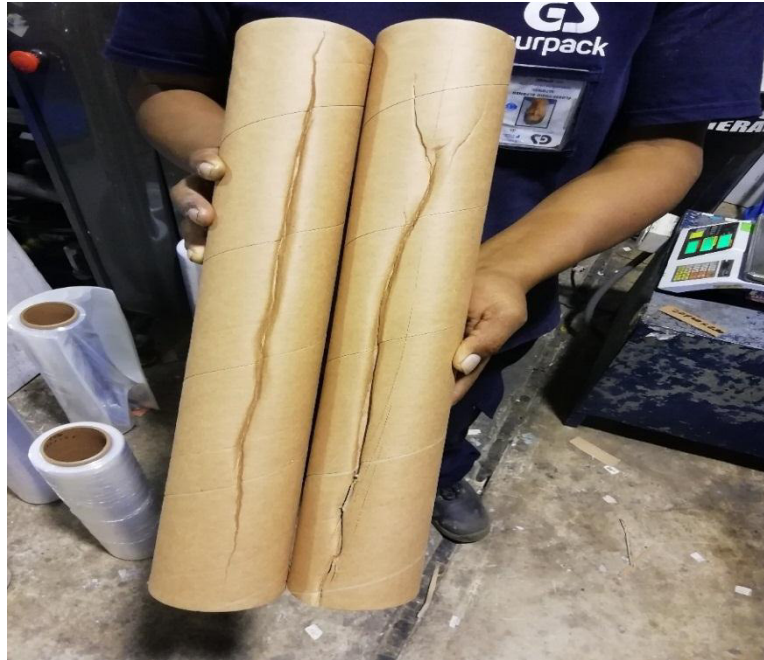
Gráfico 17. Tucos colapsados por exceso de humedad.
