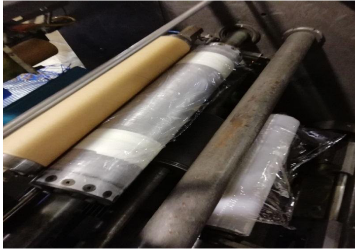
Gráfico 14. Rodillo principal de la rebobinadora 2.
