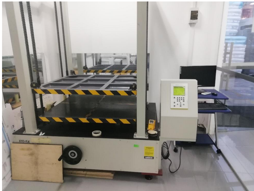
Gráfico 20. Máquina de compresión de tucos y cajas.
