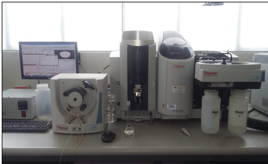
Figura 7. Equipo Absorción atómica Marca Thermo Scientific y modelo THERMO SCIENTIFIC ICE 3000 equipado con Horno de Grafito del Centro de Información, Control Toxicológico y Apoyo a la Gestión Ambiental (CICOTOX) de la UNMSM
